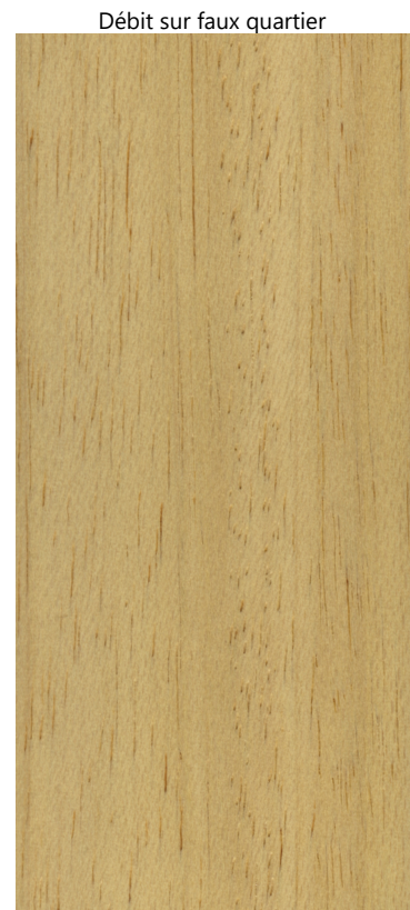
Débit sur faux quartier
